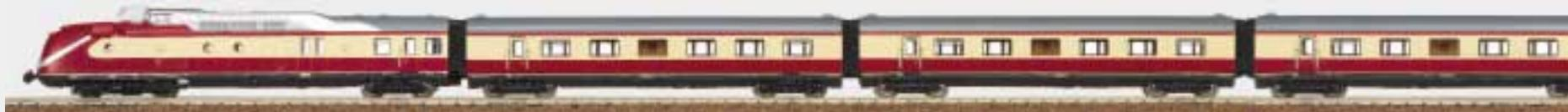
Gasturbinentriebzug BR 602, bestehend aus zwei Triebköpfen (einer motorisiert) und sechs Mittelwagen. Achsfolge B'2'+2'2'+2'2'+2'2'+2'2'+2'2'+2'2'+2'2'+2'B'. Anfang der 70er Jahre wurden vier VT 11<sup>5</sup> zu einem Gasturbinenzug umgebaut.
