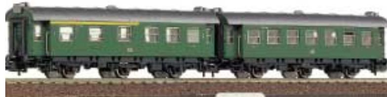
Festgekuppelte Doppelwageneinheit, bestehend aus je einem 1.-/2.-Kl.- und 2.-Kl.-Umbauwagen.
