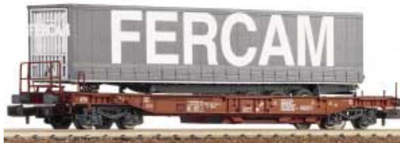
Einheitstaschenwagen der FS, beladen mit einem Schiebeleplanaufleger.
