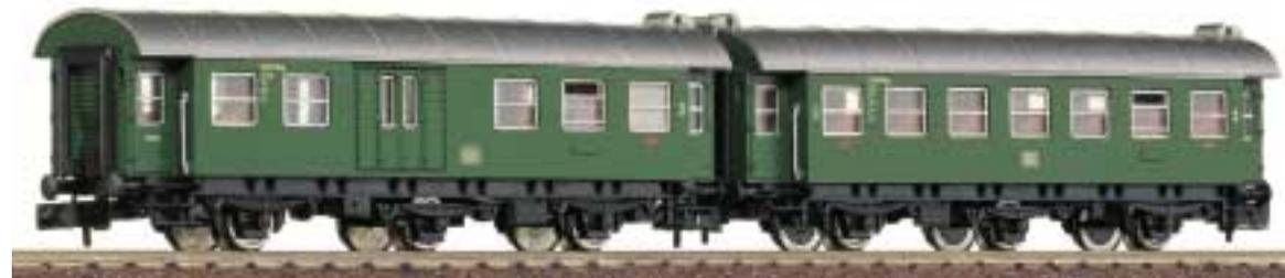
Festgekuppelte Doppelwageneinheit, bestehend aus einem 2.-Kl.- und einem Gepäck/2.-Kl.-Umbauwagen.
