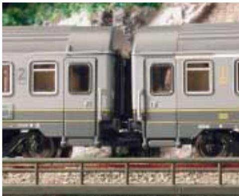
Kurzgekuppelte Modelle, ausgestattet mit Fleischmann\*-Kurzkupplungskopf 9545 (Zubehör).
