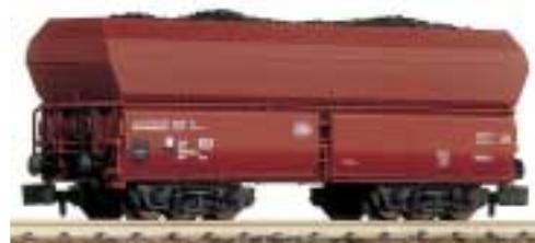
Vierachsiger Selbstentladewagen. Dieser Wagen wird sehr oft zum Transport von Kohle oder Erz in „Ganzzügen“ eingesetzt. Fac<sup>159</sup>
