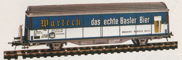
4340 F SCHIEBEWANDWAGEN der SBB (Hbis) „Warsteck Bier“. LüP 167,9 mm. 4592
