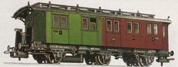
* 4211 PERSONENWAGEN (BC3iPr92c), mit Inneneinrichtung, Plattformlampen, Laternendach mit Fenstereinsätzen und aufgesetzten Lüftern, 3achsrig, LüP 135 mm.
