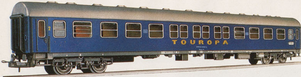
4282 TOUROPA-TURNUS-LIEGEWAGEN , (Bctüm), Drehgestelle Minden/Deutz 50, mit Scheibenbremsen, Inneneinrichtung, fein detaillierte Ausführung.
