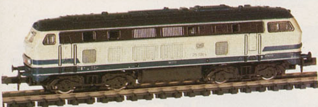
2150 B Diesel-Lokomotive der DB, V 215 in Ozeanblau-Beige-Lackierung, LüP 102,5 mm
