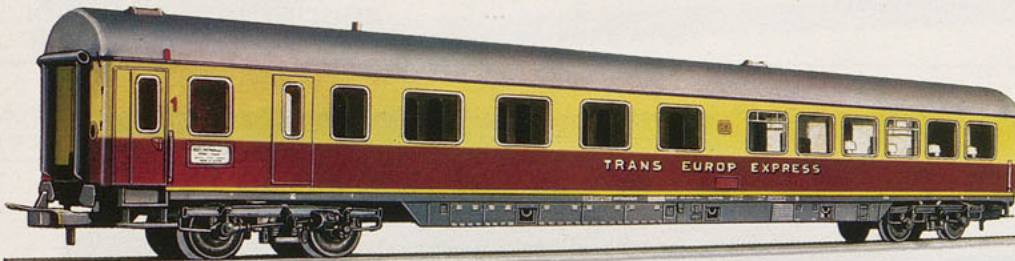
4270 TEE-BARWAGEN , (ARDüm), Bar mit Hocker und Lampen, LüP 275 mm ⇄ 4481 ⊗ 4492
