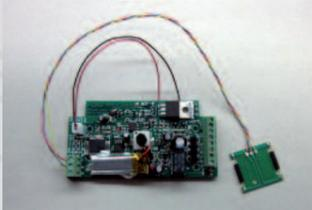
36194 Analog-Sound BR 80 Modul zum Nachrüsten der BR 80, mit dem Reedkontaktschalter #35267 können Glocken- und Pfeifensound durch den Gleismagneten #35268 ausgelöst werden. 69,99 €\*
