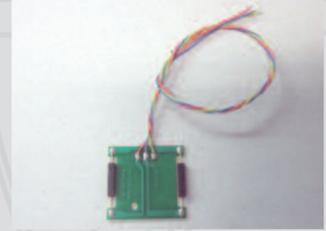
35267 Reedkontaktschalter zum Auslösen der Glocke und Pfeife des Sound-Moduls #36194 durch den Gleismagneten #35268 9,99 €\*
