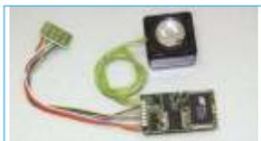
Décodeur multiprotocole format DCC avec régulation de charge, prise NEM 652 et prise SUSI, sorties 2 fonctions supplémentaires avec module sonore intégré Intellisound et haut parleur - Dimensions platine : 31 x 16.6 x 5.5 mm
