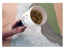
Der Grasbehälter wird maximal zu zwei Dritteln mit Gras gefüllt. So kann die Elektrostatik ihre volle Wirkung entfalten. Durch eine leichte Schüttelbewegung aus dem Handgelenk fallen die Grasfasern elektrostatisch aufgeladen in das Kleberbett.
