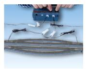
Anschluss von 4 Weichen am »RC03« mit Hilfe des Y-Kabels (Art.-Nr. 7297405)
