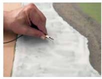
Die Krokodilklemme des Gras-Master 2.0 wird in oder in der Nähe der eingeleimten Fläche mit Hilfe eines Nagels oder einer Schraube befestigt.
