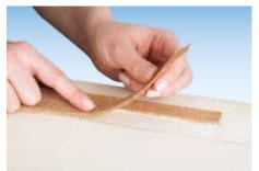
und die beiden dadurch entstandenen Streifen werden anschließend mit den »Rücken« aneinandergeklebt. Die Kork-Gleisbettungen lassen sich dadurch flexibel verlegen und folgen jedem Streckenverlauf.
