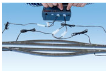
Anschluß von 4 Weichen am RC01 mit Hilfe des Y-Kabels
