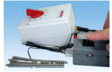
Weichenanschluss an Trafos anderer Hersteller – hier Märklin®.
