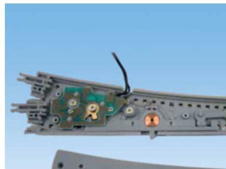
Im Bettungskörper integrierte Weichenantriebe mit den derzeit stärksten Neodym-Magneten garantieren Durchzugsstärke.
