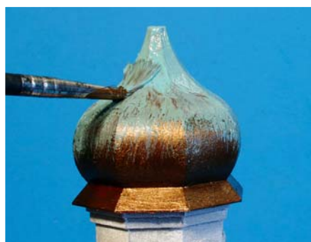
Auf die noch feuchte kupferne Farbe wird der Grünspan aufgetragen.
