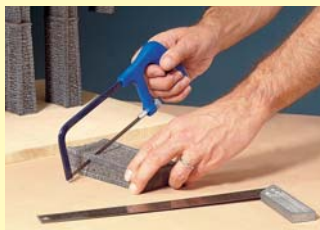
Brückenpfeiler wird gekürzt
