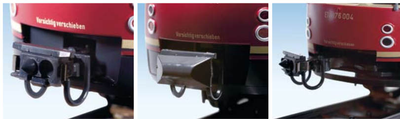
Funktionsfähige Scharfenberg-Kupplung ohne Abdeckung.
