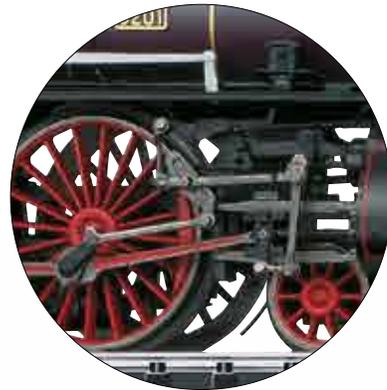
Version finement détaillée avec châssis en barres ajouré
