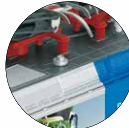
Ouverture pour gaz d'échappement avec agrafe dans le toit
