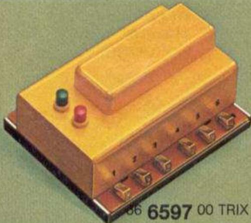
**TRIX-electronic-Schaltrelais** mit 2 Dauerkontakt-Umschaltern und Rückmeldung. Kontakte bis 20 A belastbar, beide Kontaktgruppen elektrisch getrennt. Auslösung bereits mit nur 1,5 mA (bei 14 Volt WS) und mit kürzesten Impulsen (ab 2 Millisekunden). Dauerstrom-sicher: Betätigung sowohl mit Drucktasten, Gleiskontakten oder Dauerkontakt-Schaltern möglich.
