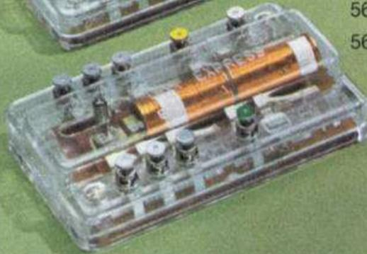
**Schaltrelais** wie 56 6591 00 mit 2 Umschaltern und Selbstabschaltkontakten.
