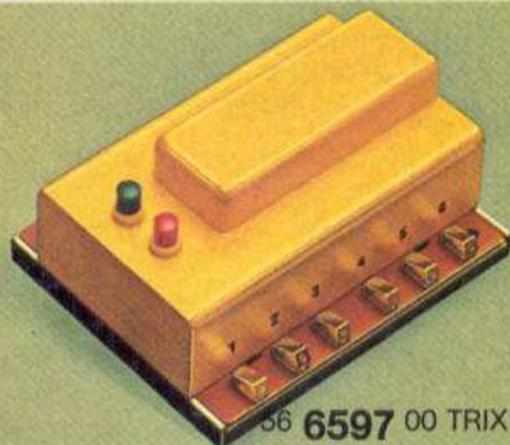
**TRIX-electronic-Schaltrelais** mit 2 Dauerkontakt-Umschaltern und Rückmeldung. Kontakte bis 20 A belastbar, beide Kontaktgruppen elektrisch getrennt. Auslösung bereits mit nur 1,5 mA (bei 14 Volt WS) und mit kürzesten Impulsen (ab 2 Millisekunden). Dauerstromsicher: Betätigung sowohl mit Drucktasten, Gleiskontakten oder Dauerkontakt-Schaltern möglich.
