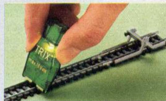
**Spannungsprüfer** Durch die eingebaute Glühlampe läßt sich die Spannung an jeder Stelle des Gleises und am Trafo kontrollieren. Auch für viele andere Spannungsprüfungen bis maximal 18 Volt verwendbar.
