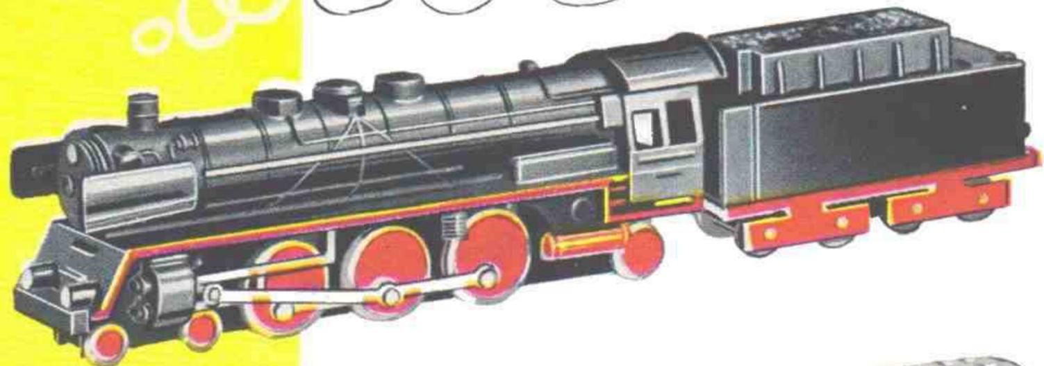
**801 ● Schnellzuglokok BR 01 ●** Achsfolge 2' C1' ● schwarz lackiert, rotes Fahrwerk, vernickelte Radkränze und Gestänge ● Länge ca. 13,7 cm ● Gewicht ca. 112 g. DM 5.75
