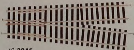
40 3845 Cuore a 9° 30' per tutti gli scambi ed incroci. Lunghezza 155 mm. 9° 30' frog section for all points and crossings. Length 155 mm.
