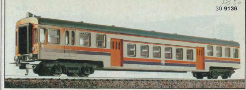
30 9136 Steuerwagen Typ nbBD in den neuen Farben der F.S. 2.Klasse Lüp 268 mm. 30 9271 Personenwagen Typ nB in den neuen Farben der F.S. 2.Klasse Lüp 303 mm. 30 9273 Steuerwagen Typ nbBD in den neuen Farben der F.S. 2.Klasse Lüp 303 mm. 30 9275L Steuerwagen Typ npBD in den neuen Farben der F.S. mit Stirnbe- leuchtung 2.Klasse, Lüp 303 mm.
