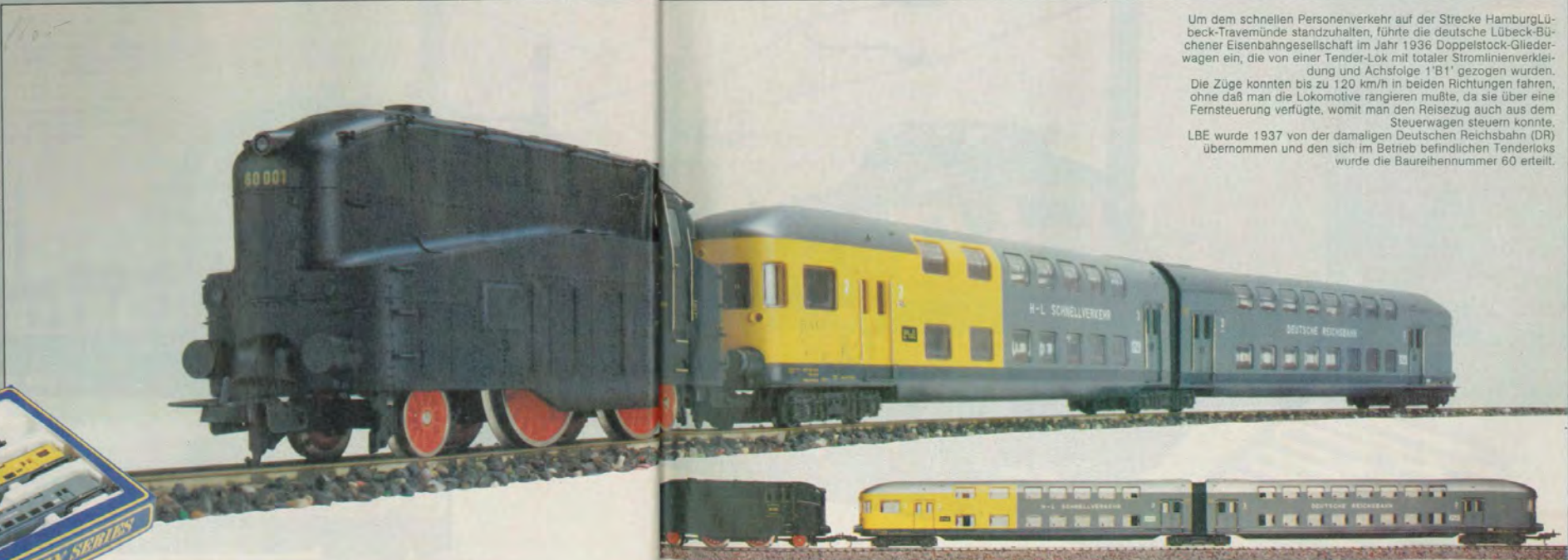
20 3019L - Stromlinien-Tenderlokomotive BR 60, Achsfolge 1'B1', mit Spitzenbeleuchtung, mattschwarze Lackierung
