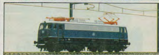
20 8138LP Schwere Reisezug-Elektrolok E 10 3 der DB. Mit federnden Dachstromabnehmern, für Oberleitung.
