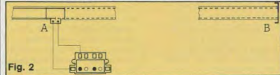
Fig. 2 Schaltplan für Abstellgleis: auf dem zwischen A und B liegenden Abstellgleis fehlt die Stromzufuhr, bis am Stellpult der Druckknopf gedrückt wird. Solange würde eine Lokomotive auf dem Abstellgleis stehen bleiben.
