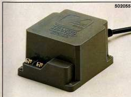
502055 Trasformatore per dispositivi elettromagnetici. Tensione di alimentazione in corrente alternata a 50-60 Hz., 220 V. Uscita 10 Volts alternata. Potenza V.A. 7.
