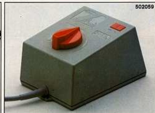
502059 Trasformatore per due treni e scambi ed accessori elettrici. Alimentazione a 220 V. Tensione disponibile in corrente continua 0-15 V. a 1,2 A. Tensione disponibile in corrente alternata 14 V. a 1,2 A. Protezione contro i corti circuiti a disgiuntore termico.
