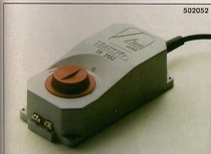
50 2052 Transformator Leistung 3,6 VA. Eingangsspannung 220 V Wechselstrom. Ausgangsspannung 0-12 V Gleichstrom. Für den Betrieb eines Zuges.
