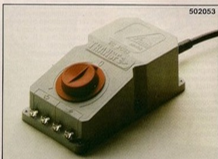
50 2053 Transformator für 1-2 Züge, sowie Weichen und elektrisches Zubehör. Eingangsspannung 220 V. Wechselstrom-Ausgangsspannung 14 V bei 0,5 A./Gleichstrom 0-12 V.
