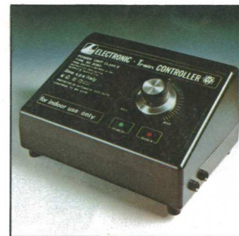
502060 Transformator für Mehrzugsbetrieb; und elektr. Zubehör. Primär 220 V. Elektronische Spannungsregelung für 0-12 V. 7,5 VA für Zugbetrieb und Wechselstrom-Ausgang 14 V. 7VA für Elektro-Zubehör. Thermo-Überlastungsschutz mit LED Anzeige.
