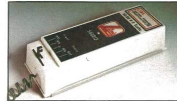
500012 Batteriekasten für 6 Monozellen à 1,5 Volt in Serie geschaltet. Ausgangsspannung 9 Volt.
