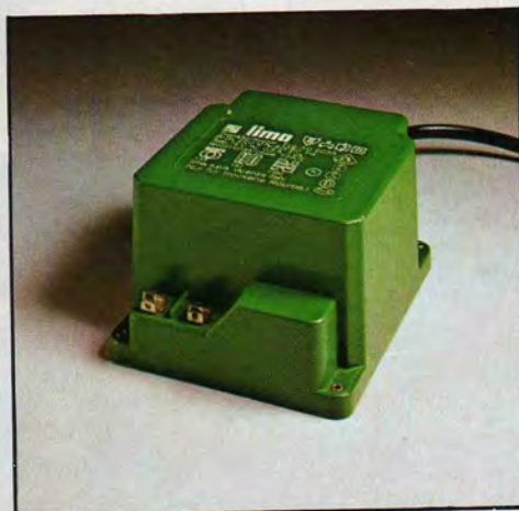
502055 Trasformatore per dispositivi elettromagnetici. Tensione di alimentazione in corrente alternata a 59-60 Hz., 220 V. Uscita 10 Volts alternata. Potenza V.A. 7.
