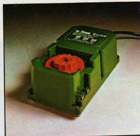
502056 Trasformatore per due treni. Alimentazione a 220 V. Tensione disponibile in corrente continua 0-12 V. a 0,6 A. Protezione contro i corto circuiti a disgiuntore termico.
