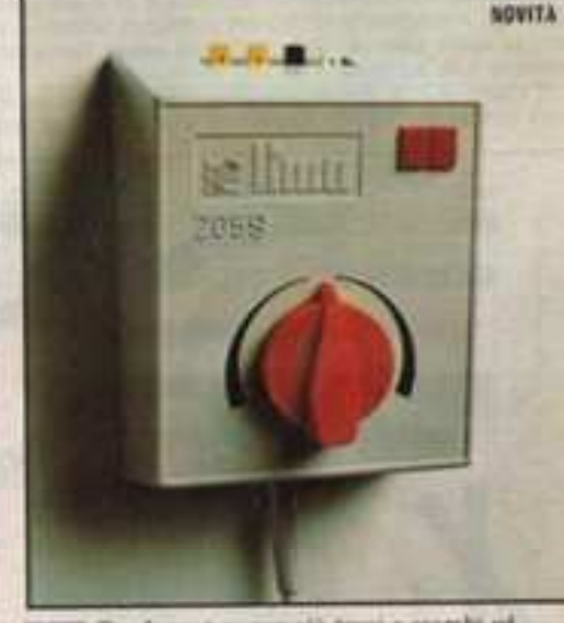
50 2068 Trasformatore per più treni e scambi ed accessori elettrici. Alimentazione a 220 V. Tensione disponibile in corrente continua 0-15 V. a 1,1 A. Tensione disponibile in corrente alternata 14 V. a 1,1 A. Protezione contro i corto circuiti a disgiuntore termico.
