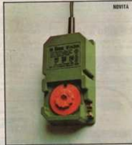
50 2066 Trasformatore per due treni. Alimentazione a 220 V. Tensione disponibile in corrente continua 0-12 V. a 0,8 A. Protezione contro i corto circuiti a disgiuntore termico.
