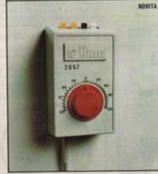
50 2067 Trasformatore per due treni e scambi ed accessori elettrici. Alimentazione a 220 V. Tensione disponibile in corrente continua 0-12 V. a 0,7 A. Tensione disponibile in corrente alternata 14 V. a 0,5 A. Protezione contro i corto circuiti a disgiuntore termico.
