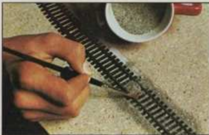
2 - spargere la sabbia lungo il binario, tra le traversine e ai lati, entro le linee di delimitazione della massiccata.
