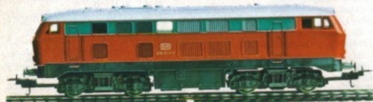
1630 L Diesellokomotive der DB. Baureihe 216. (alt. V 160) für schwere Reise- und Güterzüge. LÜP 184 mm.
