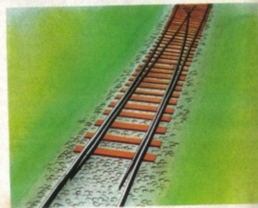
Abb. 10 Die Teile der Weiche: Die einzigen beweglichen Teile der Weiche sind die beiden "Zungen" und die dazugehörigen Verbindungsstangen. Der mittlere, feste Teil wird "Herzstück" genannt. In der Wirklichkeit wie auch beim Modellbau gibt es Weichen, die an Ort und Stelle mit der Hand mittels eines dafür vorgesehenen Hebels bewegt werden, und es gibt Weichen mit elektrischen, ferngesteuerten Stellkästen.
