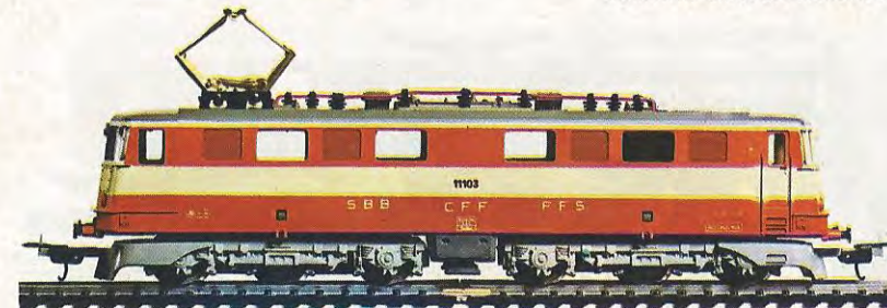
Locomotore elettrico CO-CO delle SBB CFF — Swiss electric locomotive CO-CO — Loco électrique CO-CO SBB CFF — Elektrische Lokomotive «CO-CO» der SBB CFF — Elektrische lokomotief voor forensetreinen van de Zwitserse Spoorwegen. — l. 205 mm.
