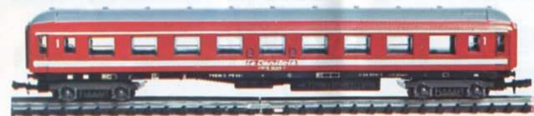
325 Vettura di 1a. classe per il treno rapido « Le Capitole », serie A o , delle ferrovie francesi (SNCF). Lunghezza fuori respingenti mm. 138. 1st class French coach for the express train « Le Capitole ». A o series, overall length 138 mm.
