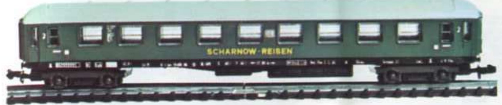
327 Vettura letto di 2a. classe tipo Bc4üm delle ferrovie federali tedesche (DB) con scritta « SCHARNOW-REISEN ». Lunghezza fuori respingenti mm. 138. Bc4üm 2nd class sleeping car of the German Federal Railways (DB) in « SCHARNOW-REISEN » inscription. Overall length 138 mm.
