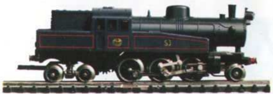
251 Locomotiva a vapore S1 delle Ferrovie Svedesi. Rodiggio 1.3.2. Lunghezza fuori respingenti mm. 85. 1.3.2. Swedish S1 Steam-Locomotive. Overall length 85 mm. Loco-vapeur S1 des Chemins de Fer Suedois, type 1.3.2. Longueur mm. 85.
