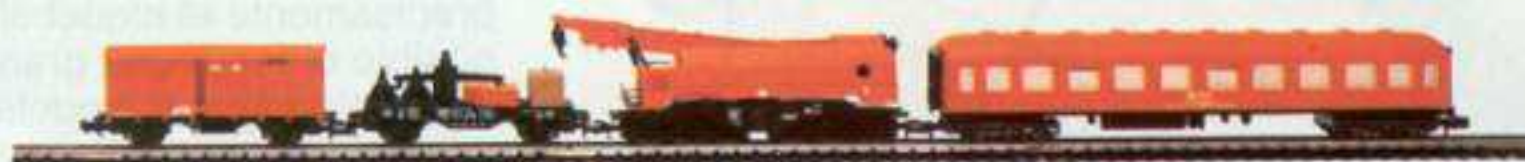
515. Equipo Unidades Servicios Especiales, 1 grúa y vagón complemento grúa, 1 coche de viajeros afecto a grúa y 1 vagón cerrado «Furgón servicios grúa».
