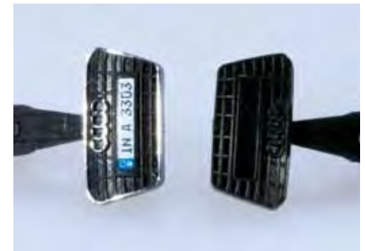
Audi-Grill vor und nach zwei Prägevorgängen sowie Drei-Farb-Druck An Audi radiator grill before and after two molding processes and three-color printing
