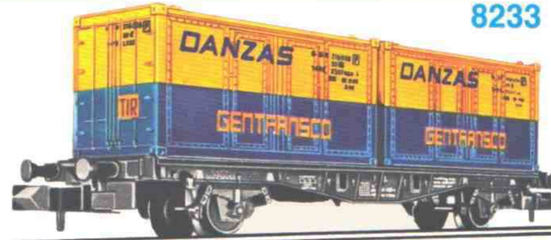
8233 · Container-Tragwagen der DB, Bauart „Lbs 598“, mit Containern der DANZAS-Speditionsges., LüP: 90 mm.
