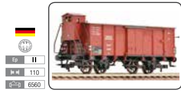
Gedeckter Güterwagen mit Bremsenhaus Bauart G 10 der DRG. Boxcar with brakeman's cab type G 10, DRG.
