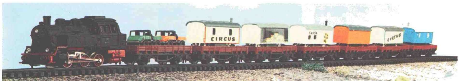
Ein Zirkus muß reisen: Auf den Niederbordwagen 0455 können alle Fahrzeuge mit Hilfe der Halteklammer 0650 aufgesteckt werden.
