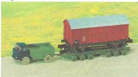
0667 Straßenroller für Güterwagen Modell eines sechsigen Straßenrollers der DB mit Henschel-Zugmaschine für den Transport von 2achsigen Güterwagen auf der Straße (ohne Güterwagen).
