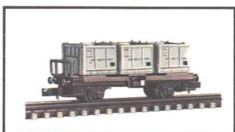
0456 Behälter-Tragwagen mit Großbehälter „Eo krt“ für grobes Schüttgut. Modell BTs 50 der DB. LüP 55 mm.
