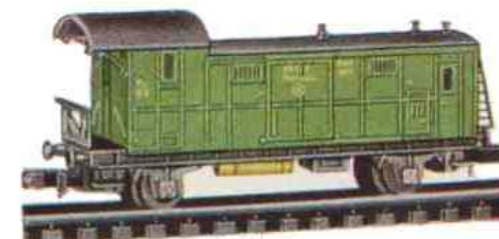
0305 Nebenbahn-Gepäckwagen DM 5,75 Modell PWi Pr 99, mit Zugführerabteil. LüP 62 mm.
