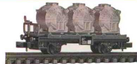
0457 Behälter-Tragwagen Bausatz DM 6,— Modell BTs 50 der DB. LÜP 55 mm. Dieses Modell ist mit 3 geschlossenen Großbehältern Efkrt für feinkörniges Ladegut z. B. Zement sowie einem Bremserstand mit beweglicher Handkurbel ausgestattet. Sonstige Ausrüstung wie 0456.
