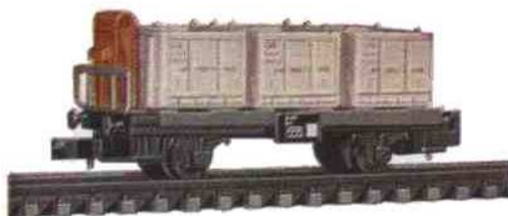
0456 Behälter-Tragwagen Modell BTs 50 der DB. LÜP 55 mm Dieser Wagen ist für den „Von Haus zu Haus“- Verkehr bestimmt und mit 3 abnehmbaren of- fenen Großbehältern Eo krt für grobes Schütt- gut beladen. Die Behälter aus Kunststoff sind fein beschriftet und silberfarbig lackiert. Das Plattformgeländer besteht aus profiliertem Metall. Einheitsbremserhaus „Villach“.
