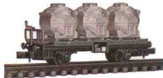
0457 B Behälter-Tragwagen Bausatz Modell BTs 50 der DB. LÜP 55 mm Dieses Modell ist mit 3 geschlossenen Groß- behältern Ef krt für feinkörniges Ladegut z. B. Zement sowie einem Bremserstand mit be- weglicher Handkurbel ausgestattet. Sonstige Ausrüstung wie 0456.
