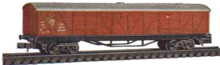
0409 Gedeckter Großraum-Güterwagen für Stück und Schüttgut. Seitlich und stirnseitige Türen, Ladeluken auf dem Dach. Modell GGths 43 der DB, LÜP 106 mm
