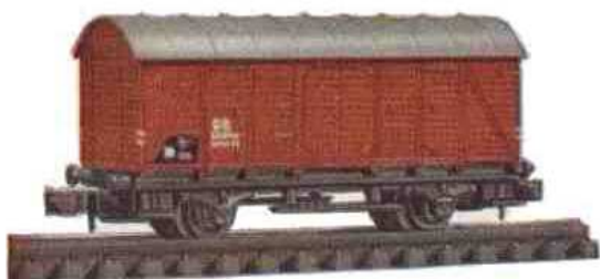
0441 Gedeckter Güterwagen Modell Gmhs 39 der DB mit Tonnen- dach. LÜP 55 mm
