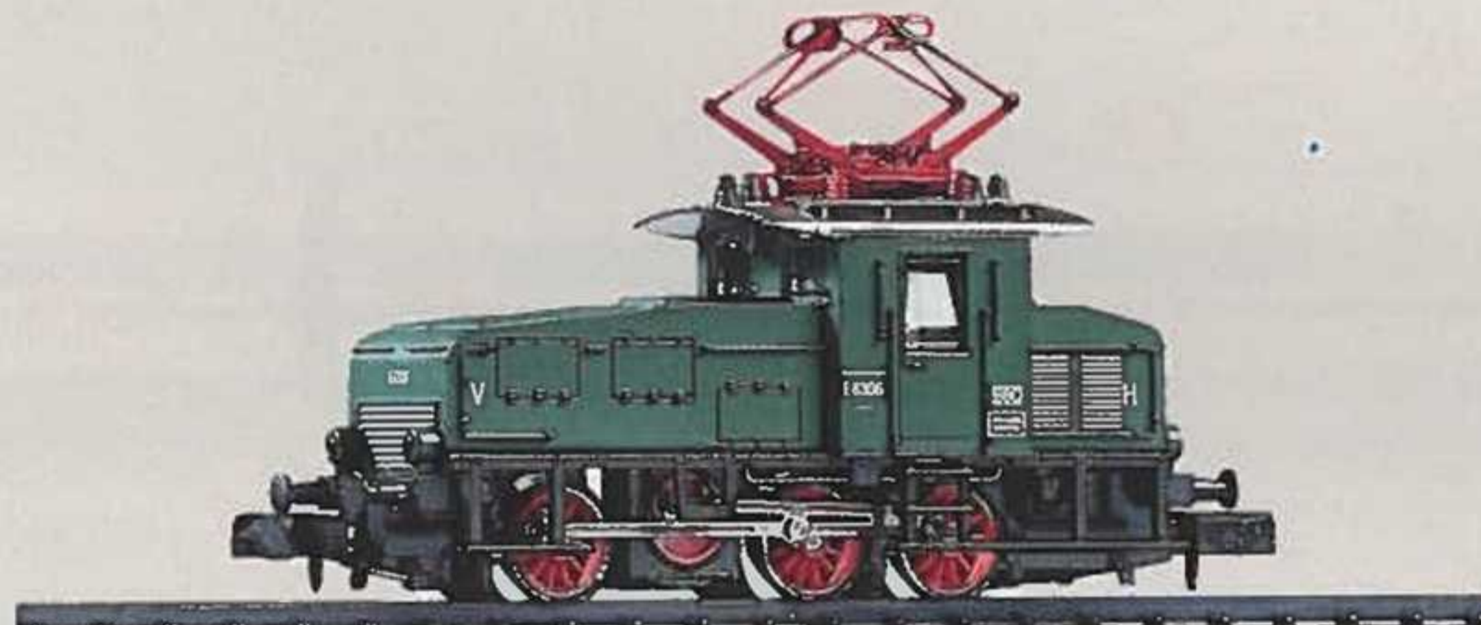
5601 Rangier-Ellok E 63 der Deutschen Reichsbahn. Von dieser Lok wurden insgesamt nur 7 Stück gebaut, die letzte Lok wurde 1978 ausgemustert. Bauart C. Vmax 50 km/h, Baujahr ab 1935, Gewicht 50 g, LüP 64 mm.
